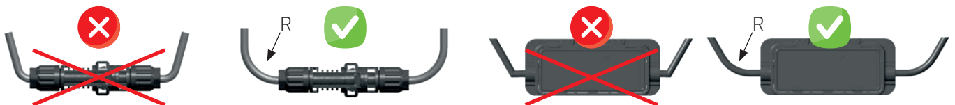
Abb. 5: zulässiger Biegeradius der Solarkabel
