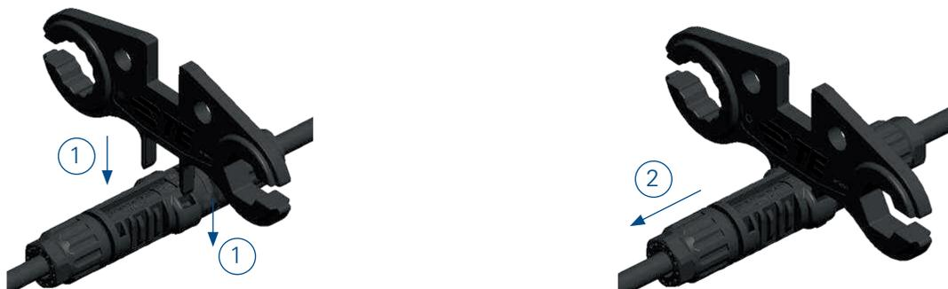
Abb. 9: Trennen der PV4-S Steckverbindung
